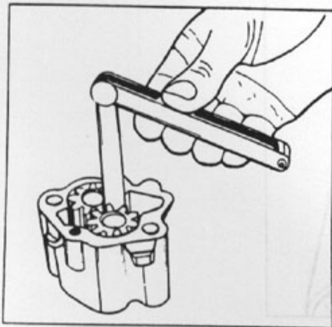
Fig.51 - Medição da folga entre dentes
