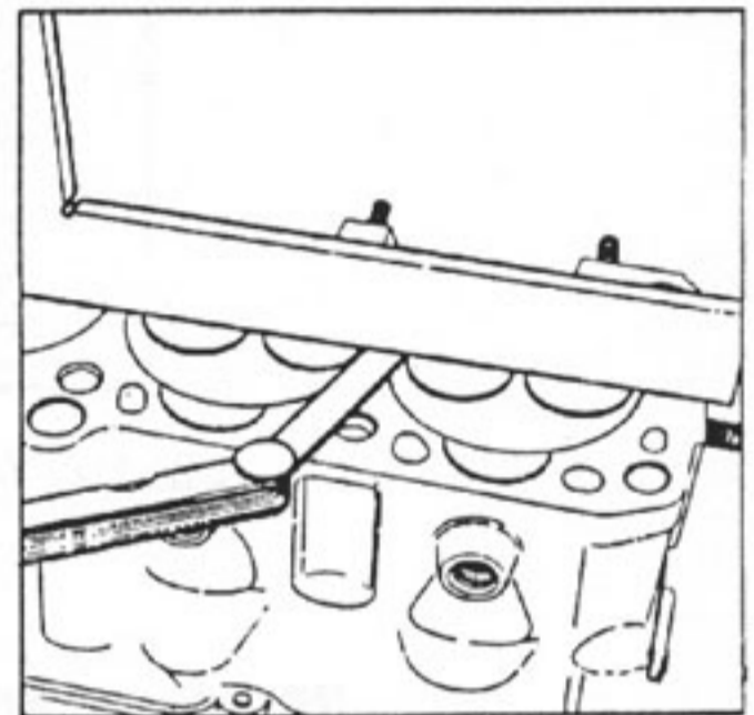
Fig.60 - Verificação da Planicidade do Cabeçote (máx. 0,10 mm)
